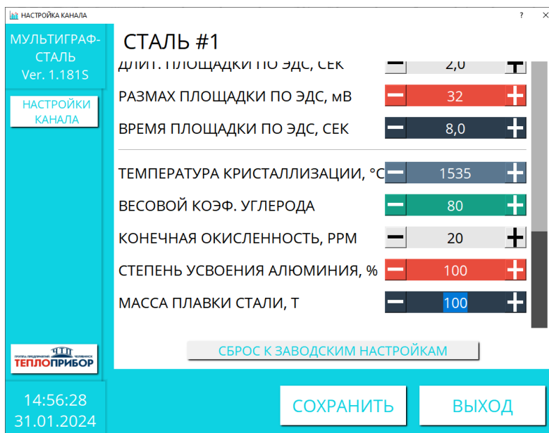
Рисунок 2.7 – Специальные параметры для расчета количества алюминия и углерода
