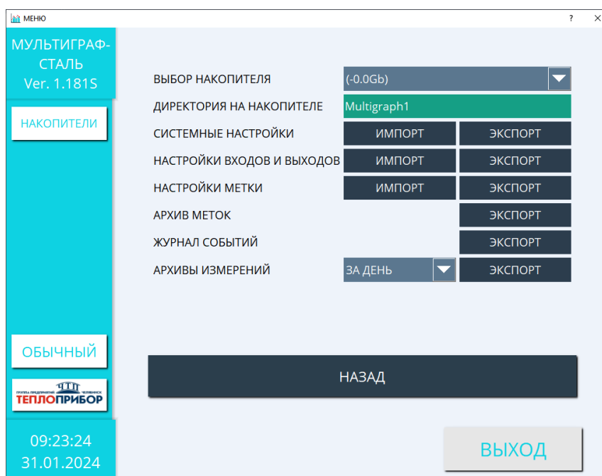
Рисунок 2.21 – Настройка внешнего накопителя
